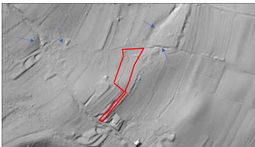
Figure II.6: Carte d'ombrage permettant d'identifier les cicatrices d'érosion (flèches bleues).
